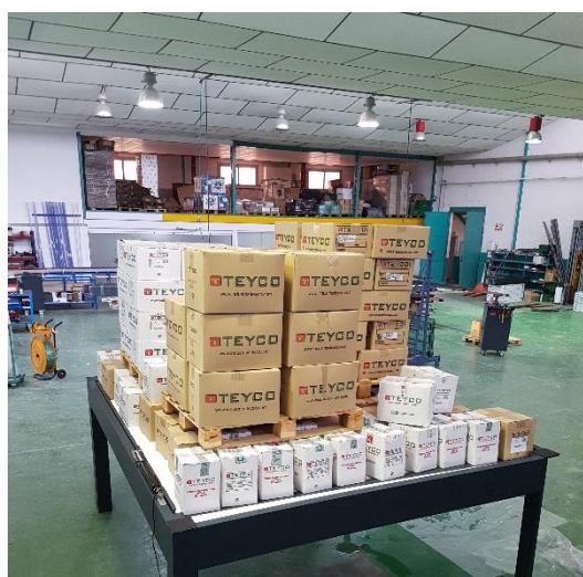
Ensayo de resistencia a carga de nieve
